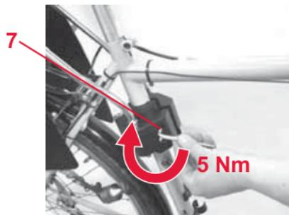
☞ Ziehen Sie die Schrauben **7** der Halterung **5** mit einem Innen-Sechskant-Schlüssel (Größe 5) mit einem Drehmoment von 5 Nm fest. Verwenden Sie das Prüfstück **X** um eine korrekte Befestigung zu erreichen.
